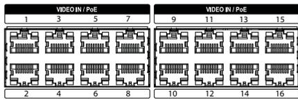
Branchez les caméras réseau ou les encodeurs vidéo sur le NVR à l'aide d'un câble RJ-45 (Cat5e ou Cat6). En plus des caméras ou des encodeurs vidéo, vous pouvez connecter des concentrateurs externes (en option : DH-2112PF, DH-2128PF) pour former un réseau. Le NVR reconnaît automatiquement les caméras réseau DirectIP™. Les ports 1 à 16 prennent en charge PoE.
